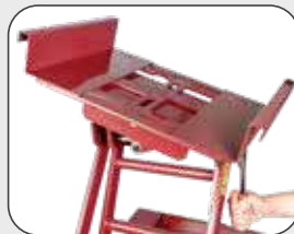
Bandeja inclinada 15° para a direita
