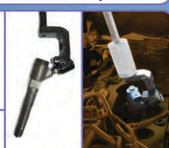
CR 363 Dispositivos para retirar bico injetor eletrônico. Carretel Rosca M27 X 1mm. Sistema (sacador com rosca) em linha, ou individual no sistema (à percussão) Acompanha adaptador para Renault Master (apoiar na caixa seca do câmbio). OBS: Os bicos devem ser de rosca M27 X 1mm e estar sem o solenóide, em condições normais.
